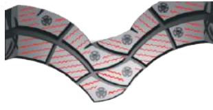
A ŞEKLİNDE KONUMLANDIRILMIŞ LAMELLER
